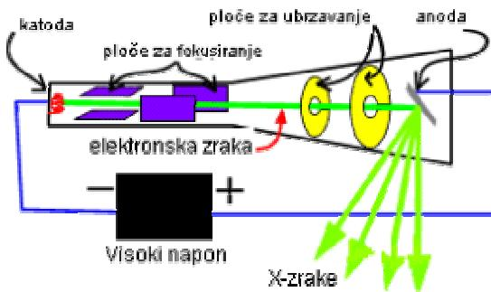
X-zrake koje nastaju kao rezultat sudara elektrona s metalnom pločom imaju širok raspon energije, međutim maksimalna energija koju mogu imati određena je razlikom potencijala između elektroda koje ubrzavaju elektrone. Naprimjer, ako je razlika potencijala između elektroda 50 keV, rezultirajuće X-zrake imat će energiju do, ali ne i preko 50 keV.
