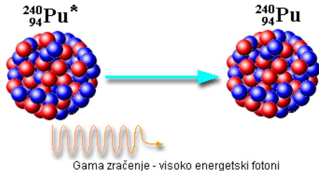
Do emisije gama zrake dolazi kada jezgra radioaktivnog atoma ima previše energije, a obično slijedi emisiju beta čestice. Cezij-137 pruža dobar primjer radioaktivnog raspada emisijom gama zrake. Neutron iz jezgre se transformira u proton i beta česticu. Dodatni proton mijenja atom u barij-137. Jezgra izbacuje beta česticu, ali još uvijek ima previše energije pa emitira gama foton da bi se stabilizirala.
