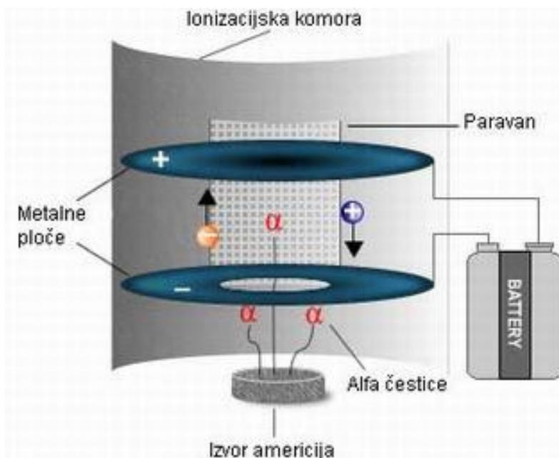
Pozitivno nabijeni atomi gibaju se prema negativno nabijenoj ploči, dok se negativno nabijeni elektroni gibaju prema pozitivno nabijenoj ploči. To gibanje stvara slabu, ali stalnu električnu struju. Kada dim prodre u ionizacijsku komoru, on ometa struju budući da se čestice dima vežu zaione i vraćaju ih u neutralno stanje čime se smanjuje tok struje.
