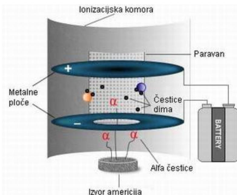
Kada struja opadne ispod određenog praga, oglašava se alarm. Ionizacijski detektori dima vrlo brzo reagiraju kod požara sa snažnim plamenom koji proizvodi malo dima.
